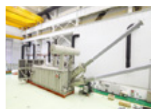
±800kV换流变压器 ±800kV Converter transformer
