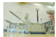
±1100kV换流变压器 ±1100kV Converter transformer
