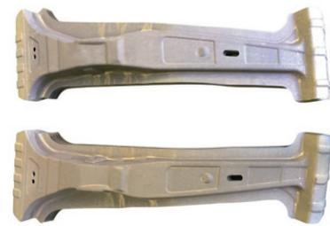
图31 热镀铝硅热成形 B柱, HC950/1300HS+AS, 1.5mm
