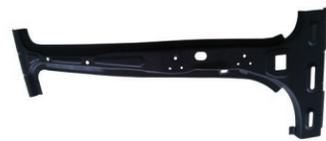
图30 热成形 B柱, HC950/1300HS, 1.8mm
