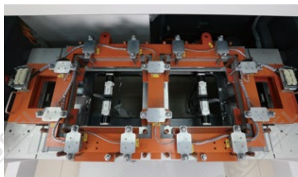
变压器铁智能测试平台
