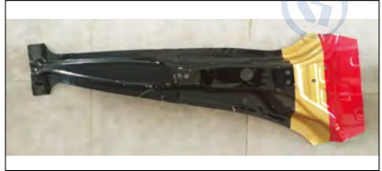
变强度热冲压 B 柱 (B1500HS, 厚度 1.2 mm)
