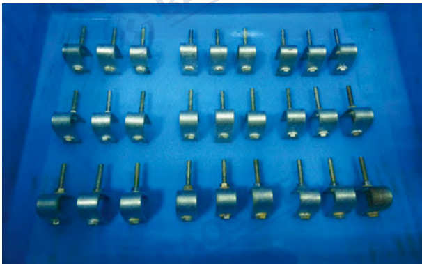
U型弯曲试样延迟开裂性能试验 (0.1mol/L HCl溶液, 300h)
