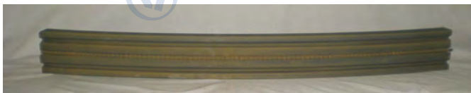
零件延迟开裂性能试验 (0.1mol/L HCl溶液, 1000h)
