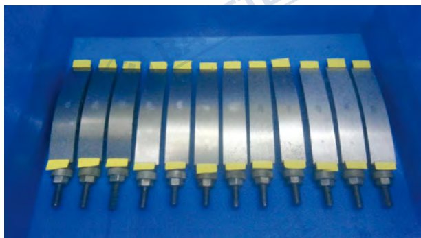
恒应力延迟开裂性能试验 (0.1mol/L HCl溶液, 300h)
