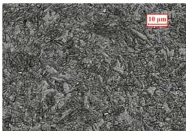
图9 1500MPa马氏体钢的金相组织照片
