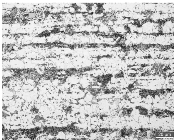
图 B.1 热冲压用钢供货状态金相组织
