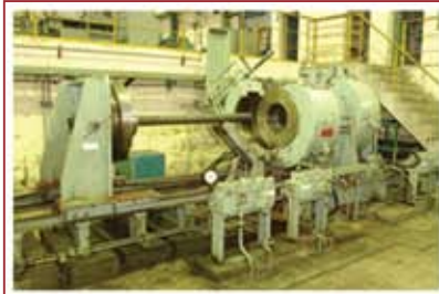
压溃试验机 Collapse tester
