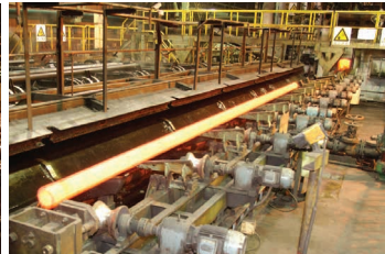
钻杆热处理 Heat treatment
